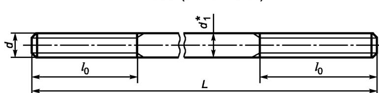
Рисунок 2 — Конструкция и размеры шпилек, лист 1
